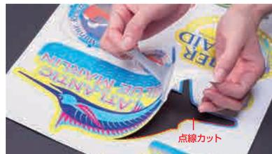
独自技術の点線カットにより、メディアを切り抜くことが可能。製作物は、わずかなつなぎめだけを残しメディアと一体になっているので、現場での作業が容易に行えます。もちろん必要ときに簡単に手ではずせます。
